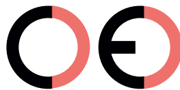
Marca CE falsa (demasiado separados)
